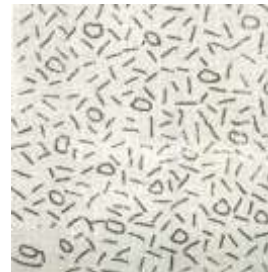
Рисунок 6 - Сталь У10 Мікроструктура після загартування і низького відпускання – мартенсит + цементит
