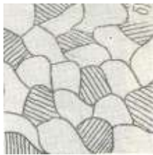
Рисунок 2 - Сталь 30ХГСА Відпал – ферит + перліт
