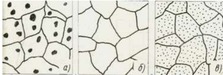
Рис.14. Схеми мікроструктур алюмінієво-мідних сплавів з 4% Cu
