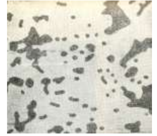
Рис.9. Свинцьована бронза БрС30 (схема мікроструктури)
