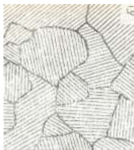
Рис. 6 Сталь 09X15H9Ю Мікроструктура після складної термічної обробки
