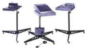
Проміжні сушарки - "підсушування" використовуються при кольорового друку (на фото: обладнання Ranar).
