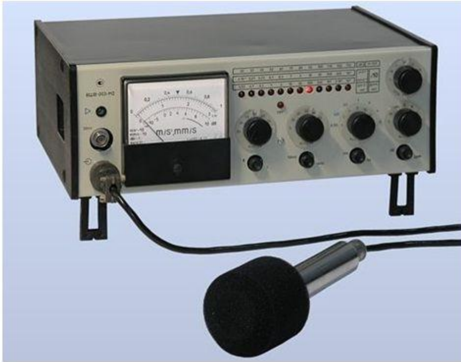
Рисунок 1.1 – Прилад для вимірювання шуму та вібрації ВШВ-1
