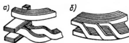
Рисунок 1.11 – Транспозиція у гвинтових обмотках
