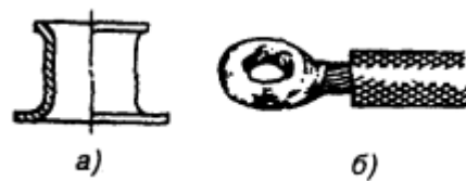
Рисунок 3.4 – Опресування багатодрової мідної жили в кільцевому мідному наконечнику: а – кільцевий наконечник; б – кінець жили після опресування кільцевим наконечником
