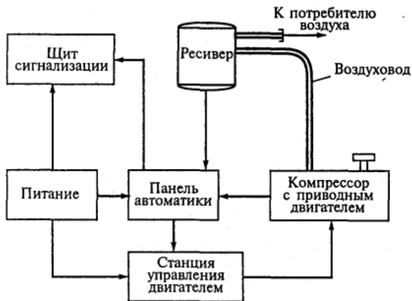
Рисунок 2.1 – Структурна схема електроустаткування компресорної станції
