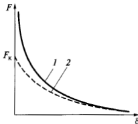
Рисунок 6.3 – Статична тягова характеристика електромагніта :
