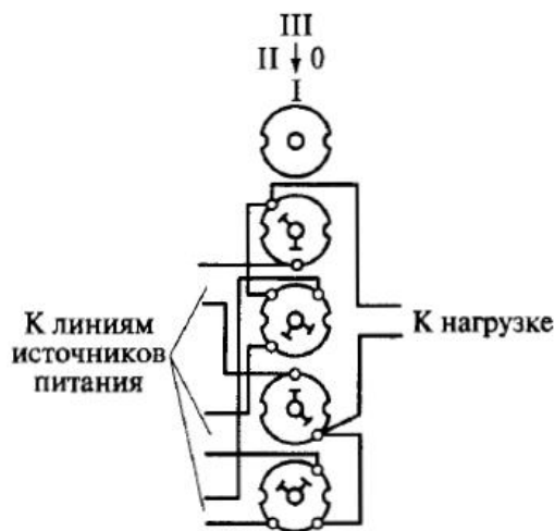
Рисунок 6.7 – Схема перемикача ПК2, що підключає навантаження до однієї з трьох ліній
