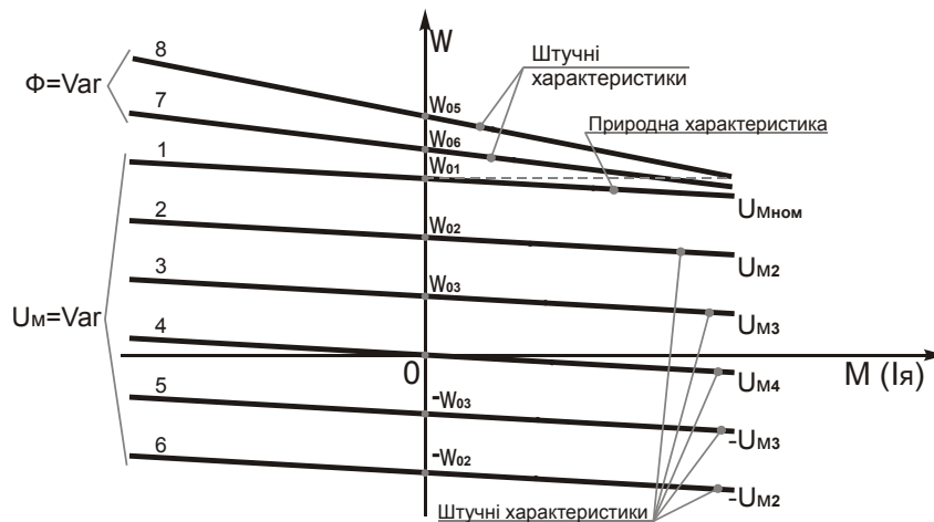
Рисунок 2 – Статхарактеристики ДПС НЗ при змінюванні напруги живлення якоря.
