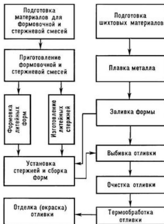
Рисунок 29.2 – Основні операції технологічного процесу здобуття відливання в піщаній формі
