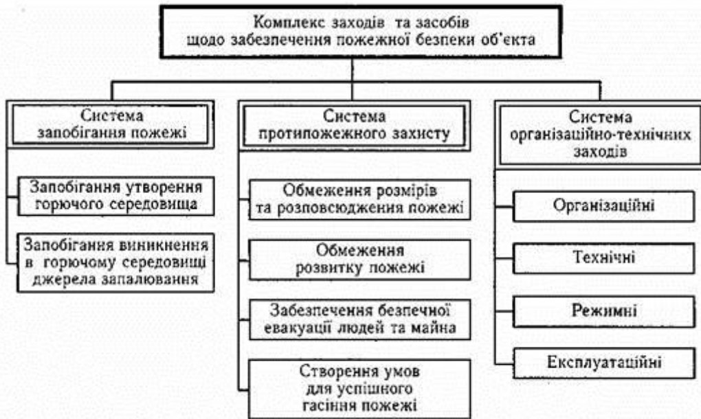
Рис. 1. Загальна схема комплексу заходів та засобів щодо забезпечення пожежної безпеки об'єкта
