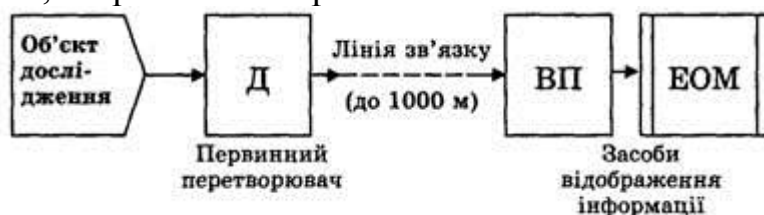
Рис. 1. Схема дистанційної передачі сигналів вимірювальної інформації
