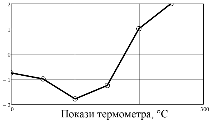
Рисунок 1 – Крива поправок термометра
