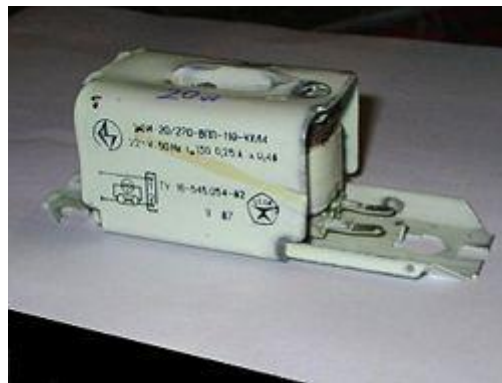
Рисунок 3.1 – Електромагнітний баласт "1УБІ20" серії 110 заводу ВАТРА, СРСР.
