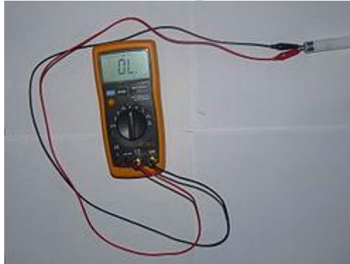
Рисунок 3.7 – Перевірка електродів одного боку на цілісність. Нескінченно великий опір говорить про те, що нитка електродів розірвана. Другою ознакою є потемніння поблизу електрода
