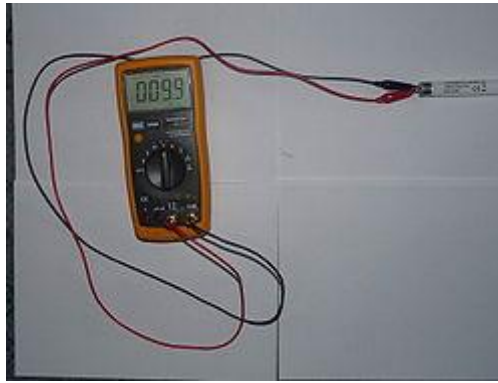
Рисунок 3.6 – Перевірка електродів одного боку на цілісність. Опір 9,9 \Omega говорить про те, що нитка електрода на цій стороні ціла.
